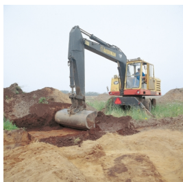
Gravemaskinen er uundværlig ved moderne udgravninger. Den fjerner muldlaget, så oldtidsanlæggene kommer til syne. I forgrunden ses en afdækket grav. Foto: T. Meyer, 1990.
